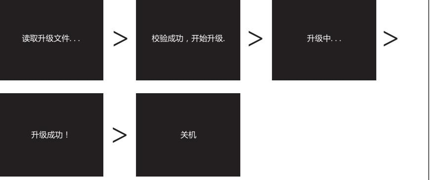
4、正确升级后，机器将自动关机。再次开机，您可以在【菜单>系统设置>系统信息】中查看最新的软件版本号。
