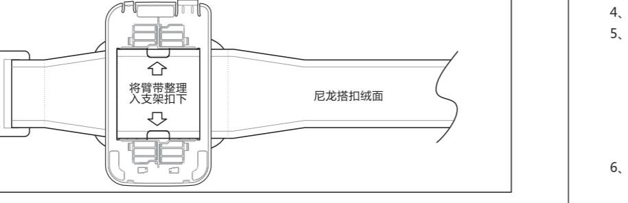
3、将整机底端斜插入支架底端，使支架下方的两个卡钩卡入整机底端凹槽，将整机上端卡入卡钩。
