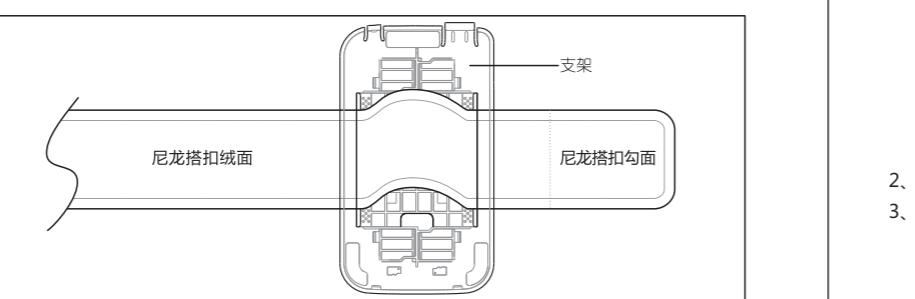
2、如下图所示，将臂带往右侧拉至尼龙搭扣绒面完全露出支架右侧，将臂带整理入支架扣下；
