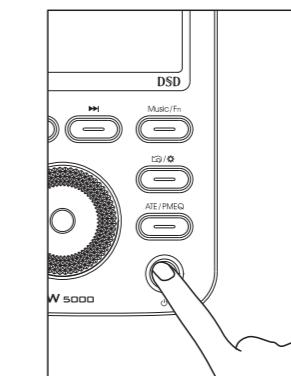
播放器开启状态时，短按“电源键”可激活或者关闭液晶显示屏。当液晶显示屏关闭时，只有“电源键”、“音量+”、“音量-”三个按键功能可用。
