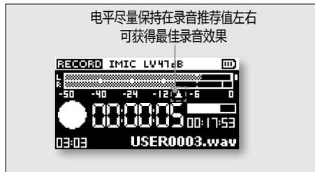
PAW-VE在录音电平计中设置了“录音电平推荐值”标志。当您手动调节增益时，请将录音电平最大值保持在录音电平计的录音电平推荐值标志左右，可获得最佳录音效果。
