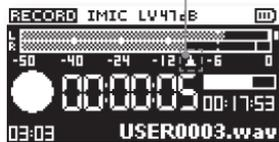
L300E在录音电平计中设置了“录音电平推荐值”标志。当您手动调节增益时，请将录音电平最大值保持在录音电平推荐值标志左右，可获得最佳录音效果。
